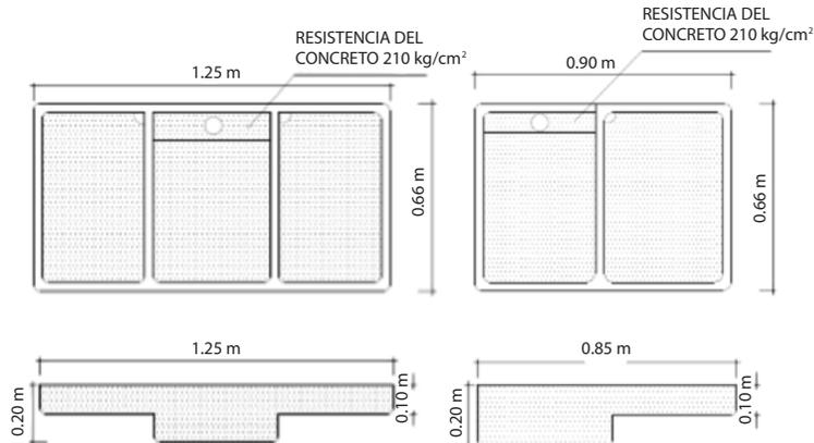
Figura 17.2 Dimensiones de las pilas de concreto
