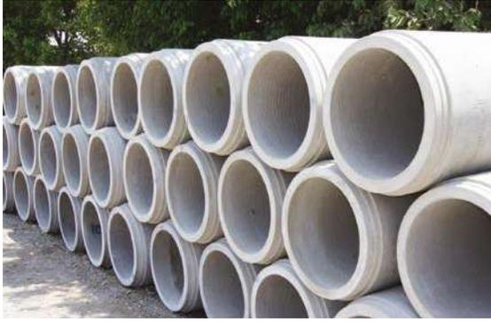
**Holcim Modular Solutions fabrica tuberías de concreto con y sin refuerzo, utilizando el sistema de prensa radial “Packer Head” y el vibrocompactado, con un estricto control de calidad.**
