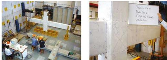
Figura 10.4 Prueba estructural de nudo viga-columna
