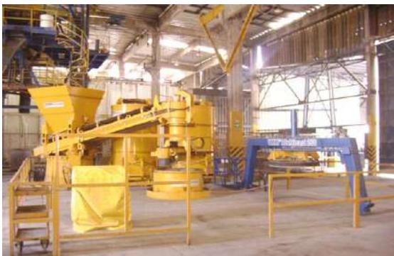
Figura 1.1 Máquina de vibrocompactado tipo Multicast 250.
