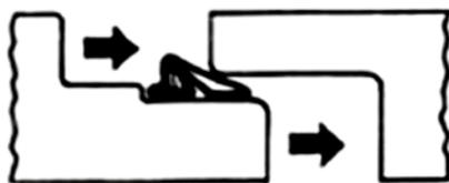
Figura 1.12 Empaque de neopreno con lubricación
