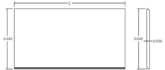
Figura 9.9 Vista longitudinal y sección transversal de una baldosa tipo estándar Prefa Holcim
