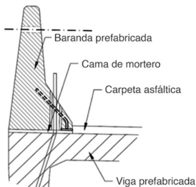
Figura 13.6 Detalle de anclaje de una baranda
