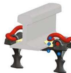
Figura 5.3 Detalle de fijación mediante clips metálicos
