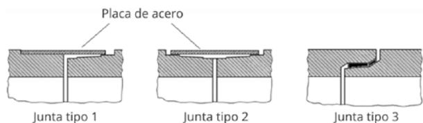
Figura 1.15 Tipos de juntas para tubería hincada
