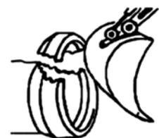
Figura 1.35 Mala práctica de instalación de tuberías
