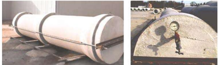
Figura 1.19 Ensamble y medición de la prueba hidrostática
