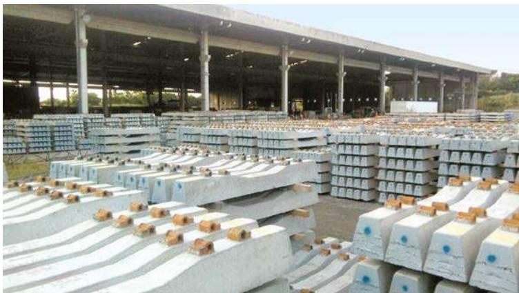
Figura 5.4 Durmientes prefabricados en la planta de producción de Holcim Modular Solutions
