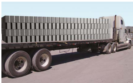
Figura 6.24 Transporte de los bloques de entrepiso
