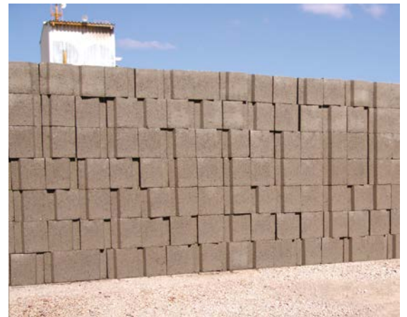
Figura 6.22 Estiba de bloques de entepiso en sitio
