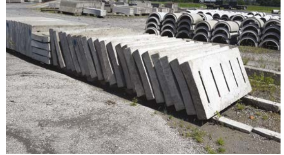
Figura 17.4 Parrillas de concreto
