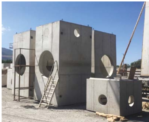
Figura 15.5.1 Cajas de registro para Proyecto de APM Terminales en Limón
