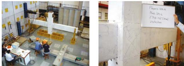
Figura 10.4 Prueba estructural de nudo viga-columna
