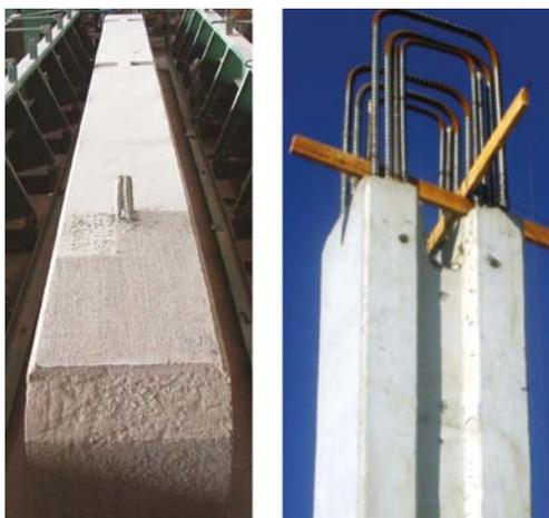
Figura 12.10 Columnas llenas sin llaves y columnas sección I (con llaves)
