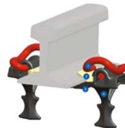
Figura 5.3 Detalle de fijación mediante clips metálicos
